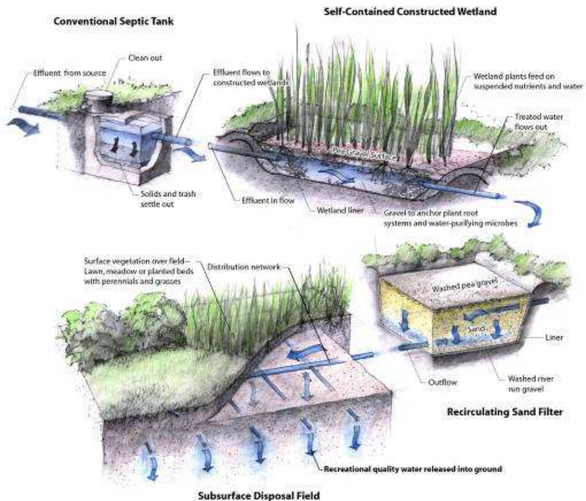
Figura 23. Sistema di fitodepurazione © 7group
